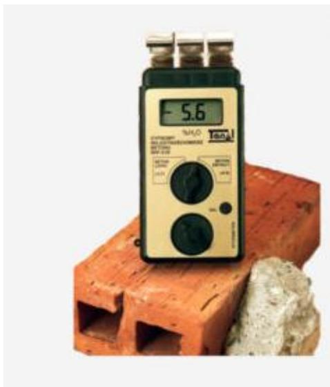
Влагомер бетона WIP-21B представляет собой электронный прибор для измерения влажности бетонного основания. Он может применяться для выполнения измерений влажности бетонного пласта перед выкладкой отделочных материалов, плиток из ПВХ, полов из эпоксидной смолы, окраской масляными красками, и др. Принцип работы прибора основан на измерении диэлектрической постоянной материала. Диапазон измерений влажности от 1% до 8% относительной влажности.
